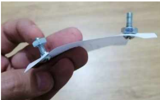
Imagen 33. Operación 4: colocación de tornillos.
