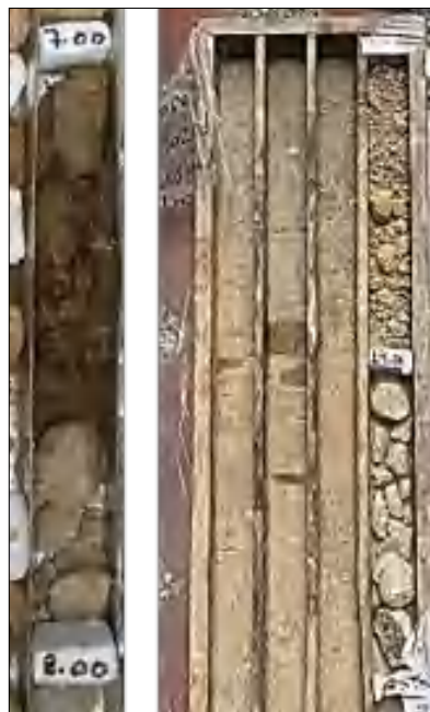
Imagen 54. Roca altamente meteorizada grado IV
